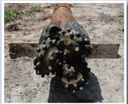
Preparación de herramientas de corte en Función del estrato de suelo a perforar.
