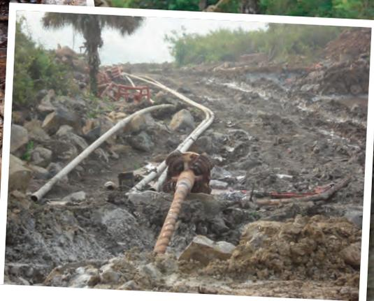
Se tuvo que usar un motor de fondo de pozo y herramientas de corte de rocas.
